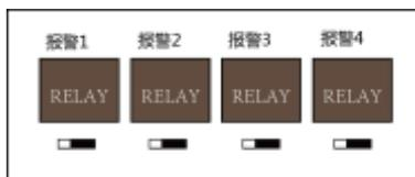
图4-3 报警继电器输出常关 (NC) 状态
