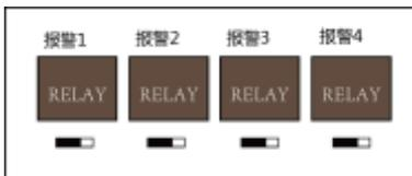
图4-2 报警继电器输出常开 (NO) 状态
