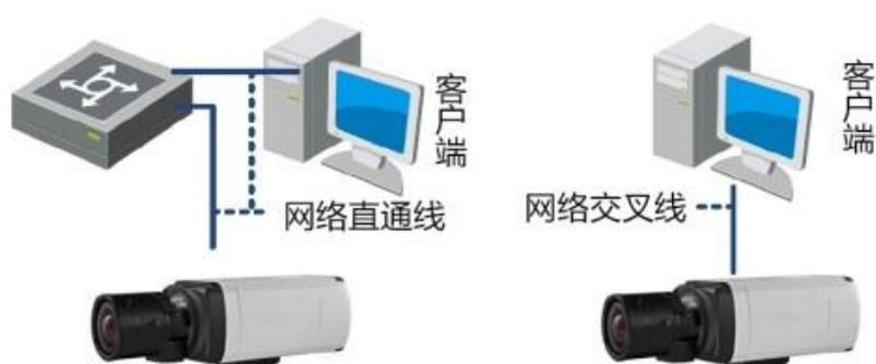
图3-1 连接示意图
