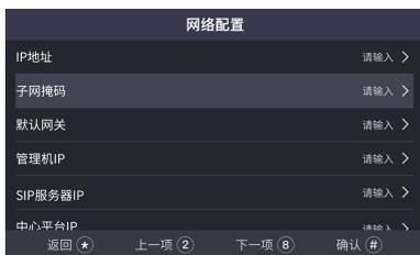
图 1-2 主门口机网络配置
