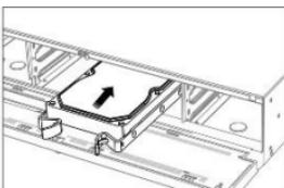
步骤3 参照图示方向, 将硬盘缓慢插入。听到“咔咔”的声音后, 代表该硬盘已安装牢固。
