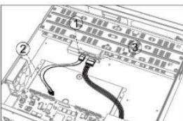
步骤3 ①将硬盘数据线一端连接在主板对应接口上②将硬盘数据线另一端连接硬盘数据线接口③将电源线连接硬盘电源接口。
