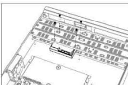
步骤2 用螺丝将硬盘固定在硬盘支架上。如果将硬盘安装在下层支架, 请先将上层硬盘支架卸掉。
