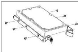
步骤1 用螺丝将硬盘固定在直插支架上。
