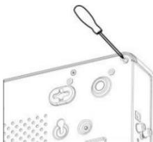
步骤3 将硬盘放置在机箱内部的硬盘盘位上，并从机箱底部用螺丝将硬盘固定。
