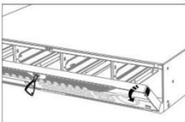
步骤2 使用配件盒中钥匙插入并转动开启面板锁, 同时按下面板两侧的锁扣, 打开面板。
