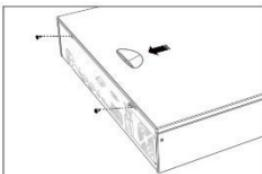
步骤1 拧开机箱背部的螺丝, 按住盖板凹槽部位, 向外用力取下盖板。
