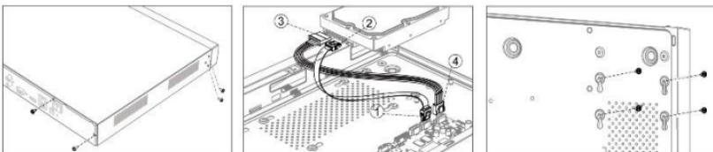
步骤1 拧开机箱背部和侧面的螺丝，取下盖板。
